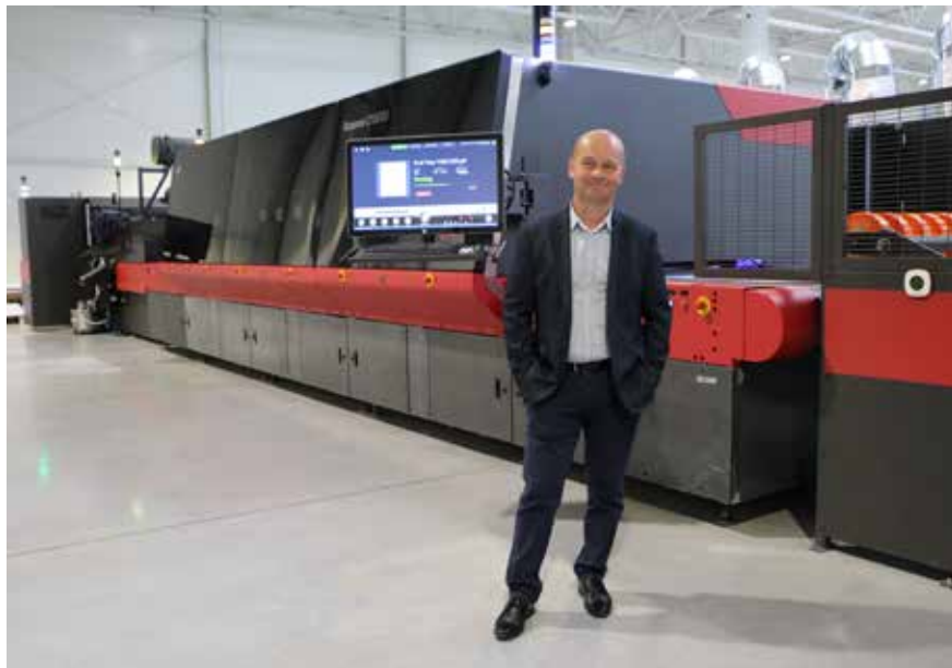
Sercem drukarni jest jednoprzebiegowa maszyna do druku atramentowego Nozomi C1800, która umożliwia drukowanie z prędkością 75 metrów na minutę.
